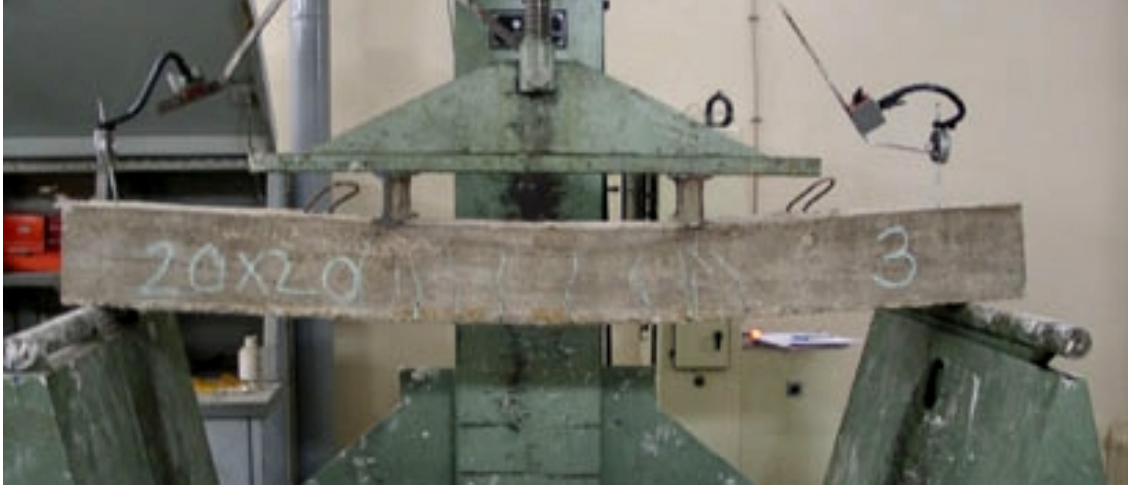
Şekil 2. Betonarme kiriş yükleme deney düzeneği
